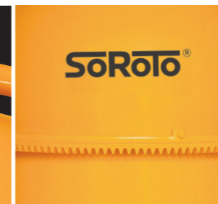
TANDKRANS AF STØBEJERN gør maskinen ekstra robust.
